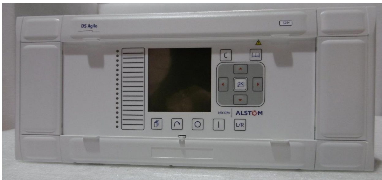
C264 with TMU210 (0,5 A / 0,05 A / 0,01 A version) and DIU221 modules
