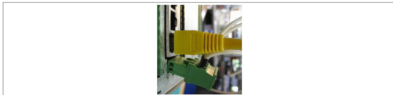
Малюнок 39: Комутатори - Порт 4 Ethernet та роз'єми сигналу несправності
