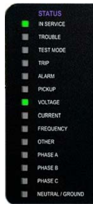
Рисунок 4-52: Приклад світлодіодів на графічній передній панелі
