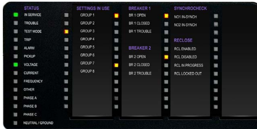
Рисунок 4-48: Типова світлодіодна панель для удосконаленої передньої панелі
