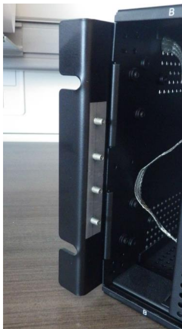
Рисунок 9-19: Приєднайте монтажний кронштейн до лівої сторони (зображена поліпшена передня панель; без модулю блоку живлення у першому слоті)
