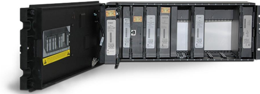
Рисунок 9-26: Модулі всередині реле з відкритою передньою захисною кришкою (поліпшена передня панель)
