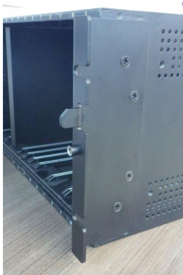
Рисунок 9-20: Прикрутіть монтажний кронштейн до правої сторони реле
