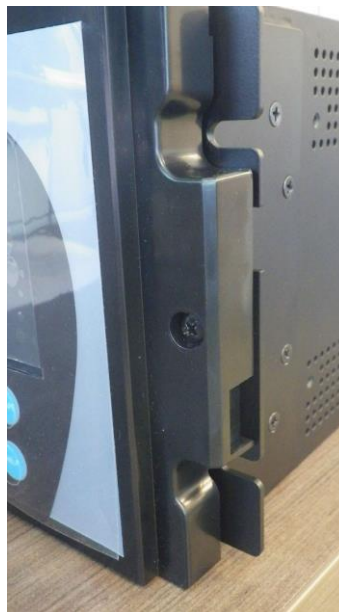
Рисунок 9-25: Гвинт для кріплення графічної передньої панелі до монтажного кронштейна
