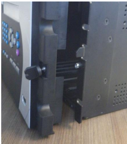
Рисунок 9-14: Зніміть монтажний кронштейн з правої сторони поліпшеної передньої панелі
