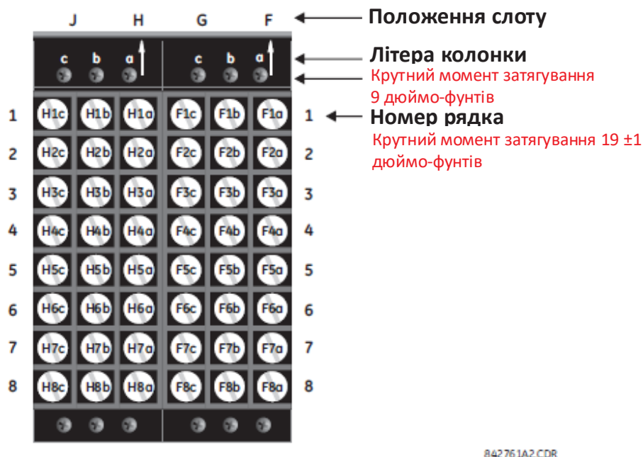
Рисунок 3-7: Приклад розміщення модулів у слотах F і H
