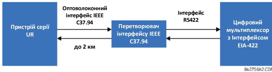
Рисунок 3-50: З'єднання IEEE C37.94 з несумісним цифровим мультиплексором
