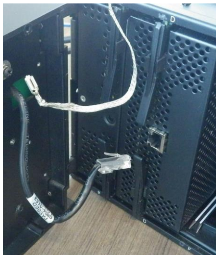
Рисунок 9-16: Від'єднайте кабель заземлення та конектор ЦП
