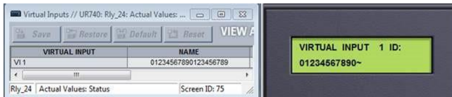
Рисунок 4-21: Відображення символу "тильда" з назвами довжиною 12 або більше символів
