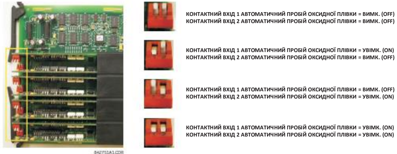
Рисунок 3-22: DIP-перемикачі автоматичного пробію оксидної плівки
