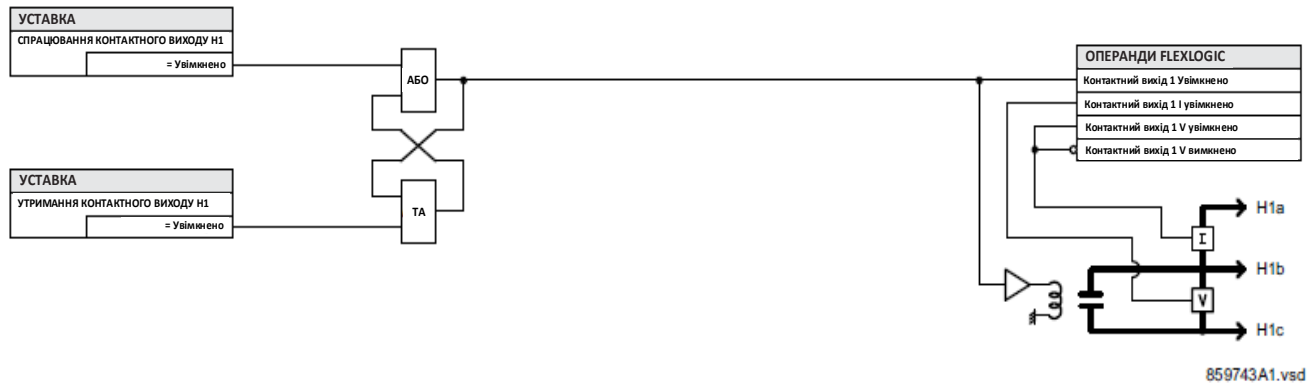
Рисунок 5-178: Логічна схема контакту 1 модуля контактних входів/виходів типу 6А
