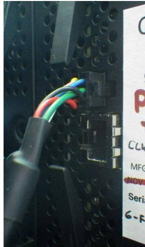
Рисунок 9-24: Підключіть графічну передню панель до верхнього з'єднання модуля ЦП
