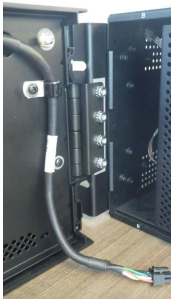
Рисунок 9-21: Прикріпіть до лівого монтажного кронштейна всередині реле
