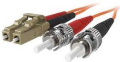
Рисунок 3-9: Оптичний роз'єм типу LC (зліва) та Оптичний роз'єм типу ST (справа)
