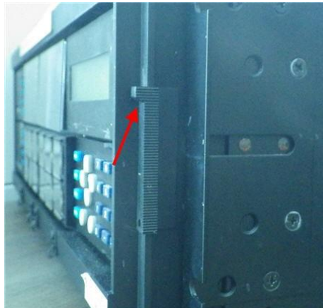
Рисунок 9-13: Підняти засувку на стандартній передній панелі, щоб відкрити
