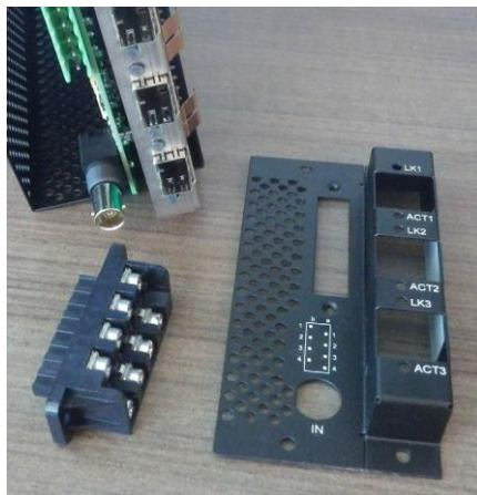
Рисунок 9-23: Задня панель модуля ЦП перед встановленням без роз'єма RS485 або захисної кришки
