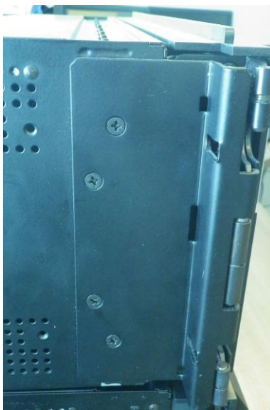
Рисунок 9-17: Відкрутіть монтажний кронштейн з лівої сторони поліпшеної передньої панелі
