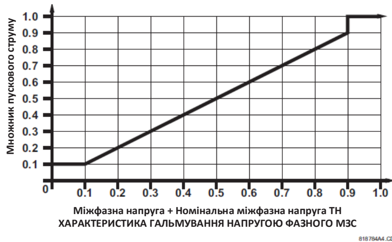
Рисунок 5-131: Характеристика гальмування напругою фазного МСЗ
