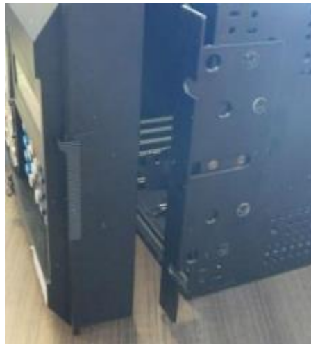
Рисунок 9-15: Зніміть монтажний кронштейн з правої сторони стандартної передньої панелі
