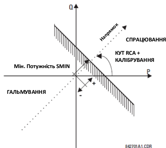
Рисунок 5-146: Характеристика чутливого елементу напрямку потужності
