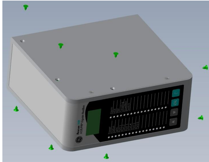
Рис. 74. Комутатор Reason H49 – Розміщення гвинтів М6, що видаляються
