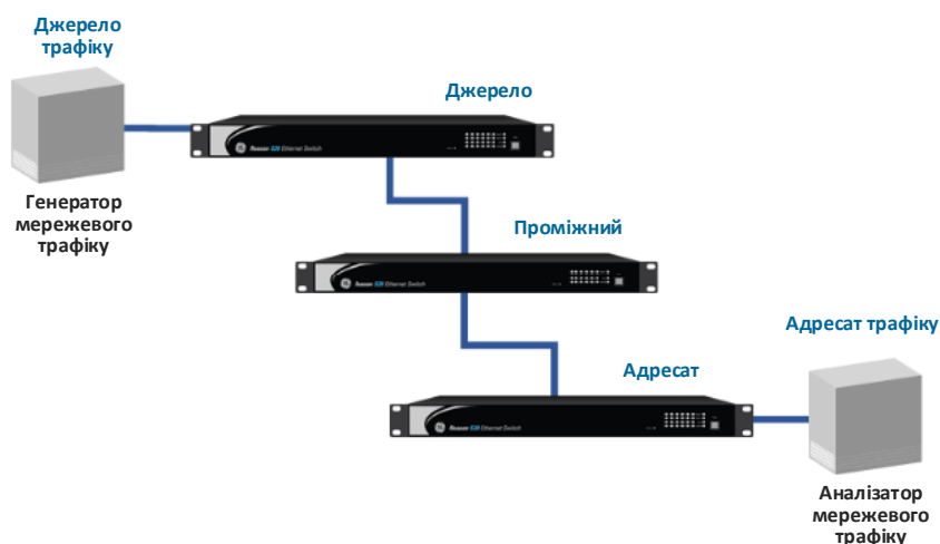
Рис. 65: Дзеркалювання портів на кількох комутаторах
