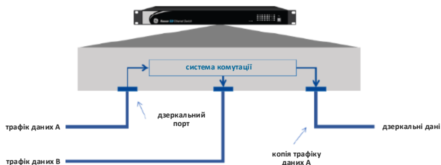
Рис. 63: Дзеркалювання портів, виконане комутатором
