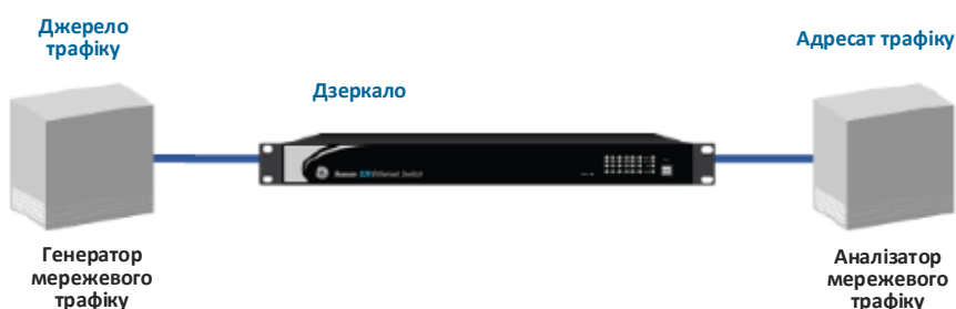
Рис. 64: Дзеркалювання портів на одному комутаторі
